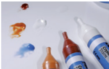
IPS e.max CAD Crystall./Shades und Stains der Spritze entnehmen und durchmischen. Bei Bedarf mit IPS e.max CAD Crystall./Glaze Liquid verdünnen.
