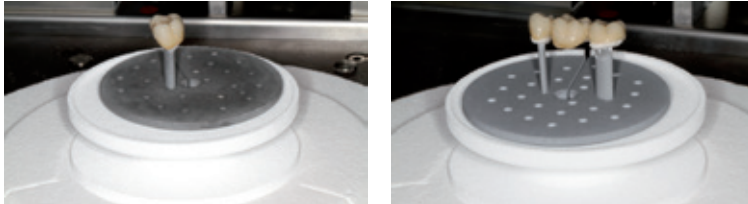
Restauration mittig auf dem IPS e.max CAD Crystallization Tray positionieren und mit dem angegebenen Brennprogramm brennen. Im Fall vom Programat CS4, auf den Sintertisch stellen.
